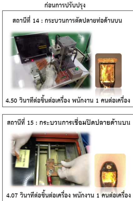
รูปที่ 2 กระบวนการตัดและเชื่อมปิดปลายท่อด้านบน ก่อนการปรับปรุง
