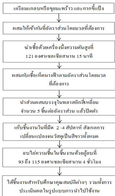
รูปที่ 2 ขั้นตอนการขึ้นรูปชิ้นงาน
