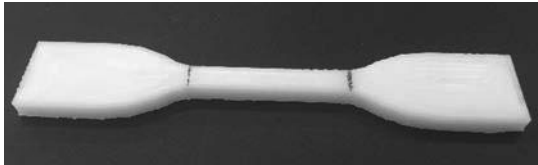
รูปที่ 4 ลักษณะชิ้นงานเพื่อทดสอบสมบัติเชิงกล
