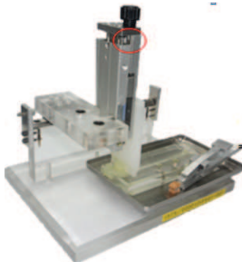
ภาพที่ 3 อุปกรณ์ปาดจารบีลงบนแท่นหลังการปรับปรุง
