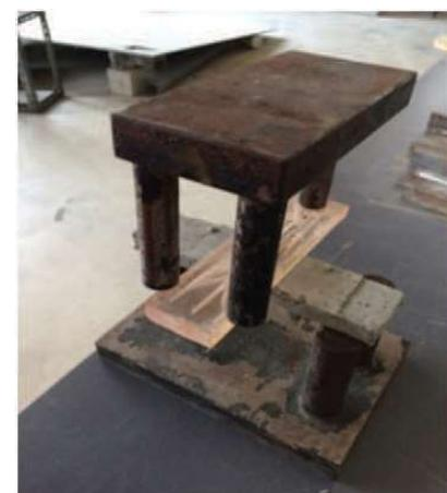
รูปที่ 2 ตัวอย่างเครื่องทดสอบแรงยึดเหนี่ยวสามขา
