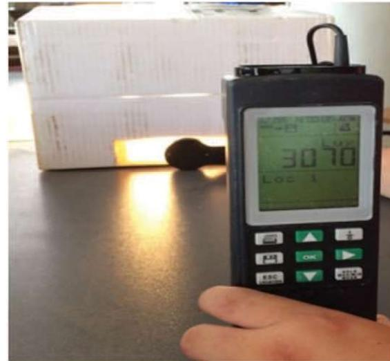
รูปที่ 1 การวัดความเข้มแสงด้วยเครื่อง LUX Meter
