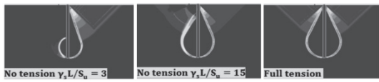
รูปที่ 9 Incremental Shear Strain Contour ของหน้าตัด แฉกคั้งที่รับเฉพาะแรงแนวราบ
